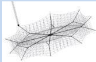
Крупногабаритная трансформируемая антенна до 40 м для КА на ГСО
