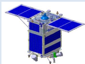
Новая универсальная платформа МКА 200 кг (связь, радиолокация)
